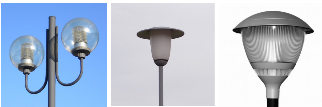
Obrázek 23: Takto NE: Nevhodná jsou nejrůznější tzv. „parková“ svítidla typu koule či polokoule bez řádného směřování světla. Jsou významným zdrojem světelného znečištění a pro osvětlení komunikací či volných prostranství by se neměla používat. Téměř vždy lze najít esteticky zajímavou alternativu, která bude dobře svítit a přitom bude šetrná k okolí.
