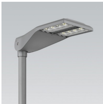
Obrázek 20: Takto ANO: příklady svítidel, která svítí pouze dolů, na oblohu neuniká žádné světlo. Rovněž při pohledu z dálky nejsou taková svítidla téměř vidět a neruší tedy ráz noční krajiny. Všimněte si plochého spodního krytu. Dá se říci, že pokud má svítidlo plochý spodní kryt, automaticky splňuje požadavky bodu 1). Svítidla používající LED by měla být vždy tohoto typu.
