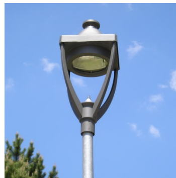
Obrázek 20: Takto ANO: příklady svítidel, která svítí pouze dolů, na oblohu neuniká žádné světlo. Rovněž při pohledu z dálky nejsou taková svítidla téměř vidět a neruší tedy ráz noční krajiny. Všimněte si plochého spodního krytu. Dá se říci, že pokud má svítidlo plochý spodní kryt, automaticky splňuje požadavky bodu 1). Svítidla používající LED by měla být vždy tohoto typu.
