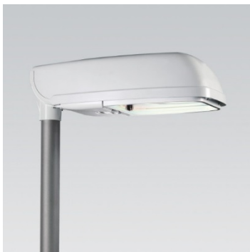
Obrázek 20: Takto ANO: příklady svítidel, která svítí pouze dolů, na oblohu neuniká žádné světlo. Rovněž při pohledu z dálky nejsou taková svítidla téměř vidět a neruší tedy ráz noční krajiny. Všimněte si plochého spodního krytu. Dá se říci, že pokud má svítidlo plochý spodní kryt, automaticky splňuje požadavky bodu 1). Svítidla používající LED by měla být vždy tohoto typu.
